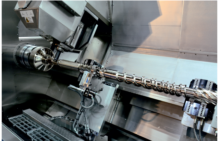
4 Schneckensbearbeitung auf einer M50: WFL präsentierte unter anderem mit 'ScrewCAM' eine neue Software zur Programmierung von Plastifizierschnecken mit komplexen Geometrien. Mit an Bord sind unter anderem zwei Lünnettenschlitten, eine U-Achse für Aussteuerwerkzeuge sowie IKZ mit 150 bar Druck © Hanser
